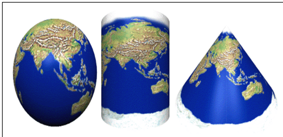
圖 9 地圖投影示意圖(中間一組即為 TM 使用之圓柱投影)
