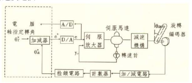
進入伺服放大器的控制訊號為  $e_A = e - y_v$ ,其中e為轉角位置誤差,即  $e = \theta_r - y_p$  , $y_v$ 為測速計的輸出訊號。所以
