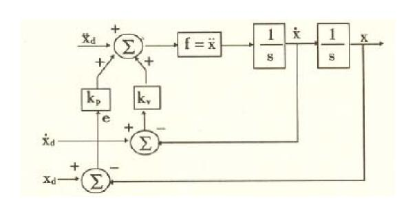
當  $k_v = \pm 2\sqrt{k_p}$  時系統處於臨界阻尼狀態,而 臨界阻尼通常視爲設計時期望的狀態。
