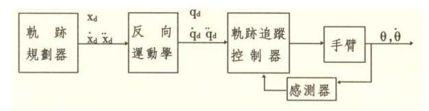
另外亦可將位置輸出訊號經順向運動學轉換到直角座標位置閉迴 路校正,此改進系統方塊圖如下:
