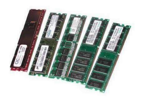
有時電腦開機螢幕並無顯示任何畫面,若主機板上有插上 2 條 RAM,試將一條 RAM 拔起再開機試試(拔起主機板上的任何零件請在電腦關機狀態下並且總電源關掉或插頭拔起狀態);若主機板上只有裝上一條 RAM,請不嫌麻煩的將他拔起使用較細的衛生紙或橡皮擦輕擦拭再插回主機板上試試。(P.S 若主機板上有 2 條 RAM,開機卻無法進入 Windows XP 畫面,可先將一條 RAM 拔起並只使用一條 RAM 試試,若可正常開機請進入 Windows XP 後再正常關機,最後再把另一條 RAM 插入再試試。)
