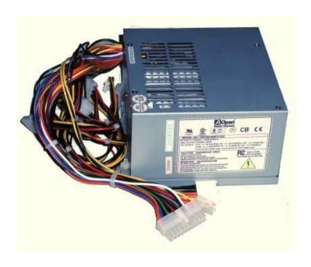
電源供應器在按下開機按鈕時電腦並無任何反應 (例: CPU 風扇並無轉動、指示燈並無亮起...等等), "有可能"是電源供應器燒壞;一般只需將主機板上的鋰電池卸下在裝上應可正常啟動電腦。那電源供應器有無損壞的檢測方式,可將電源供應器的 20P (有些主機板是 24P) 的接頭裡的綠線於旁邊的黑線搭接 (可使用迴紋針或其他方式來做), 黑線是裡面的地線, 記住一定要搭黑線。但並不是所有的黑線都是共地! (P.S 再做測試時請將電源供應器所接的硬碟、光碟機、4P 接頭 (CPU 風扇附近) 通通拔除)。
