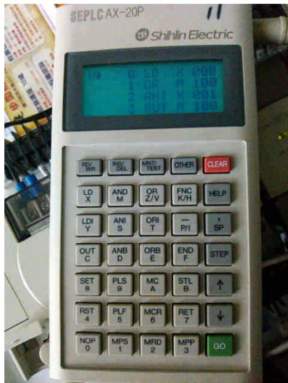
5.程式 KEY 完後關電拔下 HPP 程式書寫器插入另一台 PLC 同樣於 OFF LINE 模式下按 OTHER 鍵鍵入選項 3.
