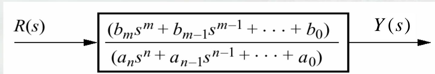
Ex: 試求轉移函數  $T(s)$ ，若  $r(t)=1$  試求  $y(t)$
