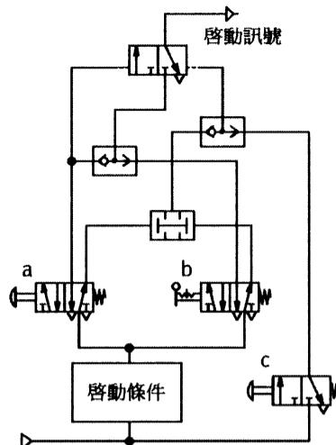
8. 下圖的邏輯表示是①  $Y=a\bar{b}$  ②  $Y=aR + \bar{b}\bar{R}$  ③  $Y=(a+R)(\bar{b}+\bar{R})$  ④  $Y=(a+R)(b+R)$  。
