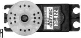
318. 【 A 】 市面上小型的多軸機器人關節大都採用定位型伺服機，如圖所示，此伺服機的內部結構不包含何者？(A)光學編碼器 (B)控制電路板 (C)直流馬達 (D)減速齒輪組
